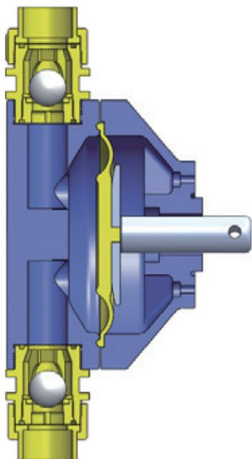
В мембранных дозирующих насосах за счет возвратно-поступательного движения мембраны в дозирующей головке насоса сперва создаётся разрежение на стадии всасывания, а затем резкое увеличение давления на стадии нагнетания.
