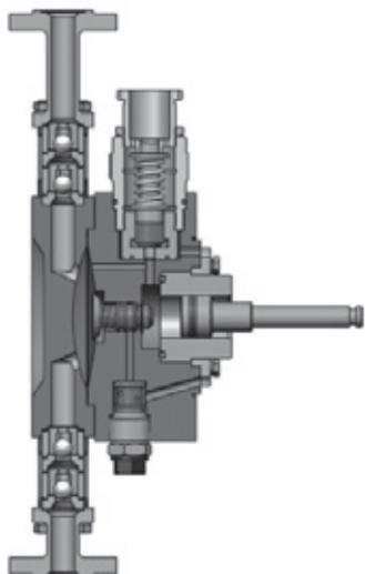
Возвратно-поступательное движение поршня внутри гидромеханической части, заполненной маслом, оказывает воздействие на мембрану, при помощи масла. Мембрана создает разрежение при всасывании жидкости и избыточное давление при ее нагнетании.
