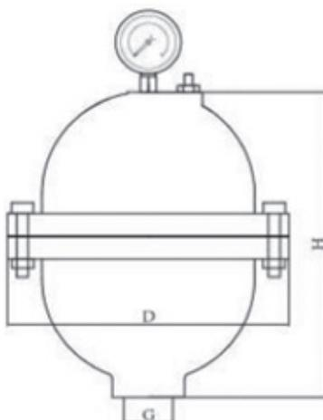
**Габаритные размеры баллонного демпфера пульсаций из PVC**
